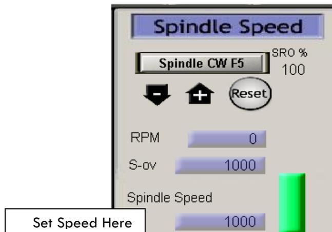
FIGURE 30 SPINDLE SPEED IN RPM
