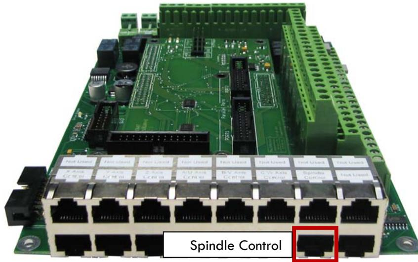
**FIGURE 21 SPINDLE CONTROL RJ45 MOD JACK**
