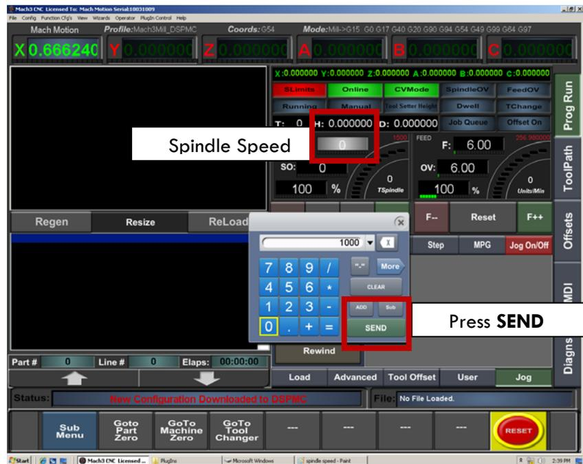
FIGURE 29 SETTING UP SPINDLE SPEED
