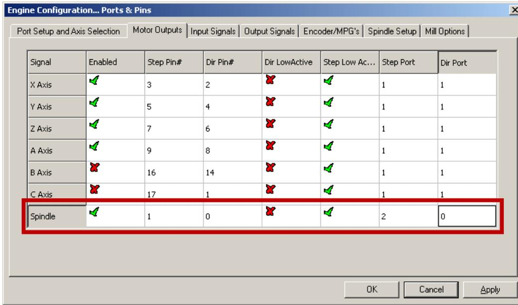
FIGURE 24 SPINDLE SETUP
