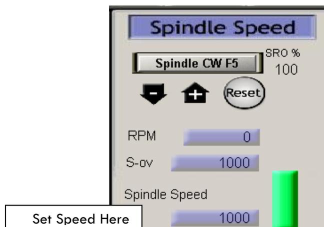
FIGURE 30 SPINDLE SPEED IN RPM
