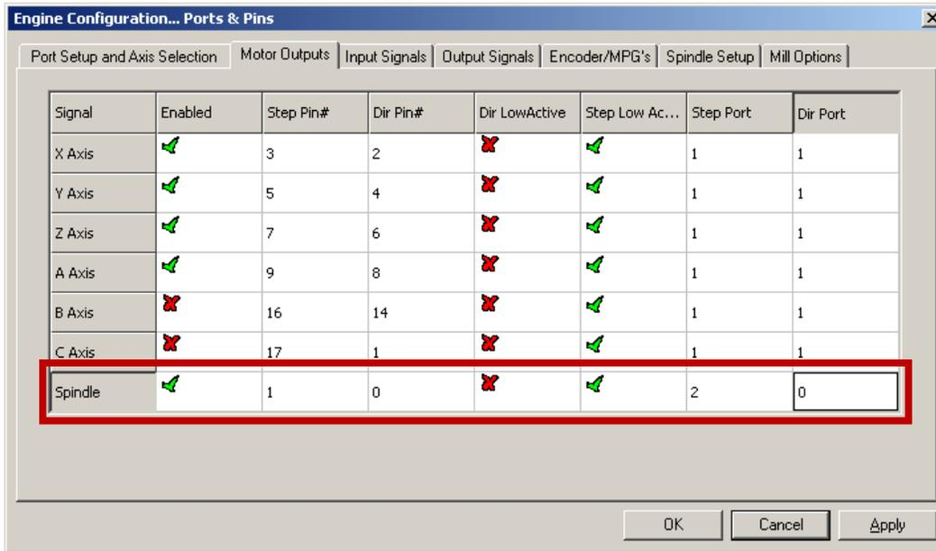
FIGURE 24 SPINDLE SETUP
