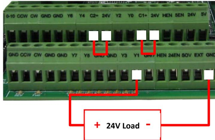
FIGURE 49 STANDARD 24V 125MA OUTPUTS
