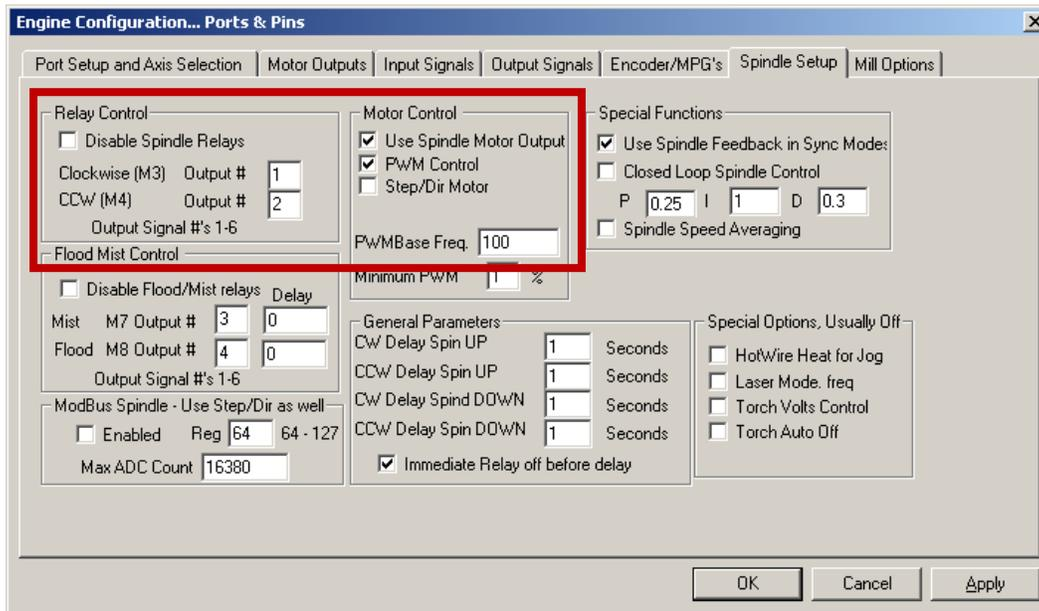
FIGURE 26 SPINDLE SETUP
