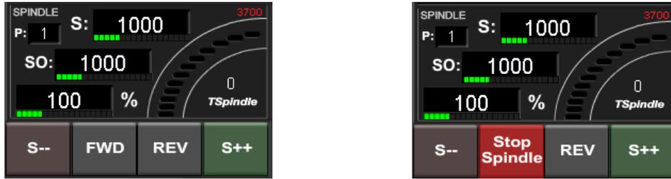
FIGURE 31 SPINDLE BUTTONS
