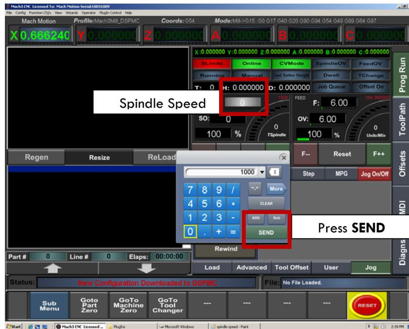
FIGURE 29 SETTING UP SPINDLE SPEED
