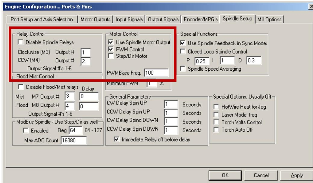
FIGURE 26 SPINDLE SETUP
