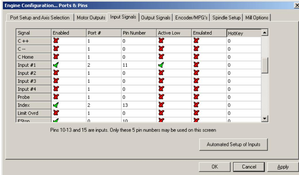
FIGURE 47 INPUT CONFIGURATION
